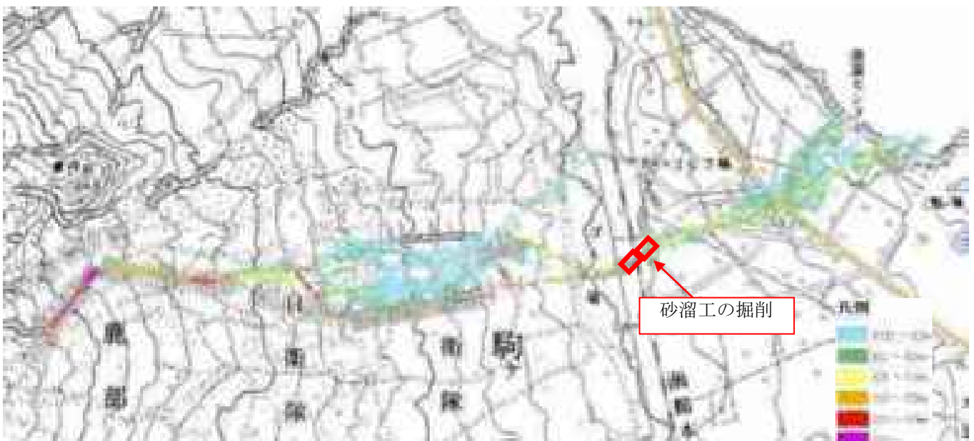
図 2.16 鹿部押出沢川における緊急ハード対策の効果（降雨型泥流）
