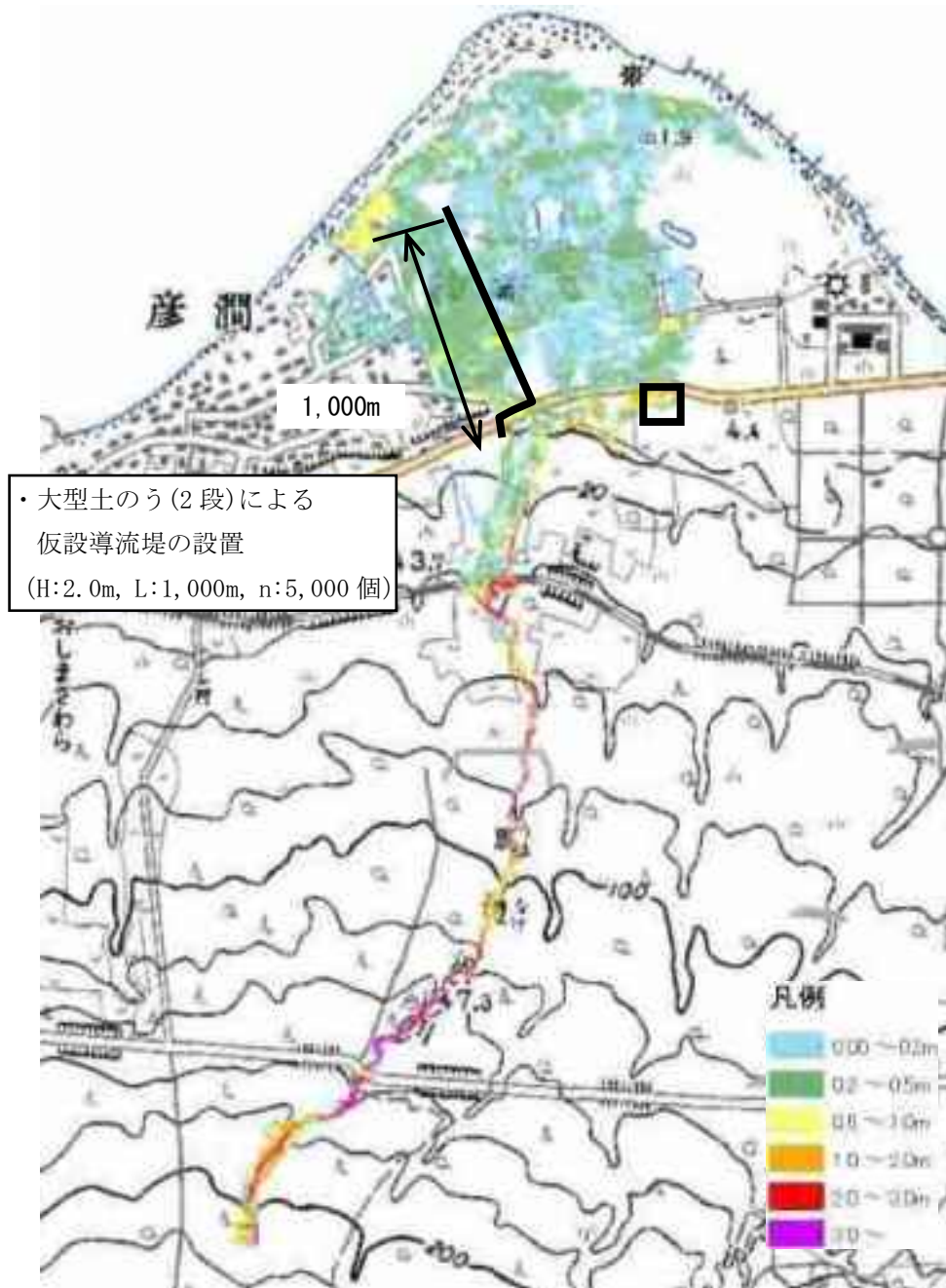
図 2.12 馬抛沢川の緊急減災ハード対策配置案(降雨型泥流対応)
