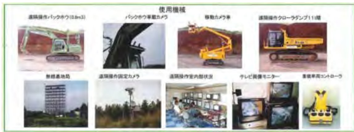
図 5-1 無人化施工で使用する主な機材
