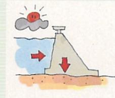
□ バットレスダム（扶壁式鉄筋コンクリートダム）
