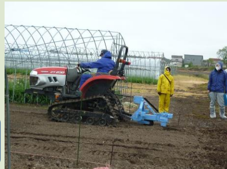
写真3 排水改善の実証 (カットドレンmini) 機材は試験場より借用
