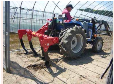
写真2 パラソイラ施工 機材は試験場より借用
